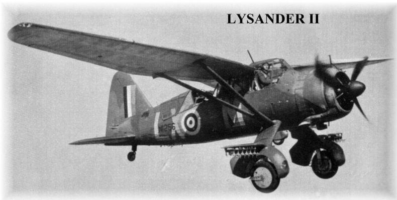
**Lysander II** : Construit en 442 exemplaires, fut livré en septembre 39 ,118 avions furent abattus durant la bataille de France. On remarque les 2 mitrailleuses de 7.7m/m Browning dans le carénage des roues et une mitrailleuse sur pivot dans le cockpit arrière.
